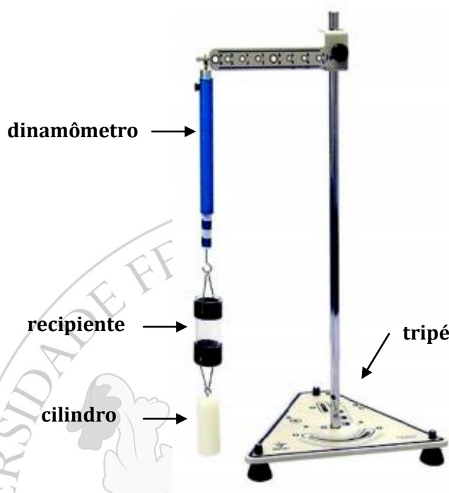
Figura 3 – Montagem experimental para realização do experimento: Princípio de Arquimedes.
